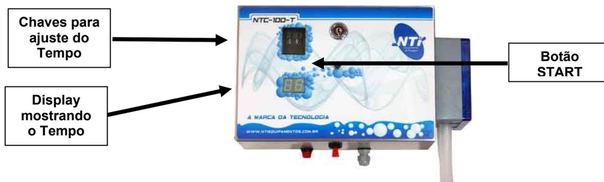
Para iniciar a Dosagem do produto basta apertar o Botão START, neste momento o NTC 100T irá iniciar a dosagem pelo tempo programado nas chaves. No display vai aparecer o tempo restante para o final da dosagem. Para interromper o processo basta desligar o equipamento na Chave Liga/Desliga.
