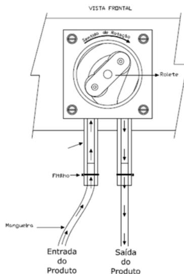
O Tubo de Nylon que fará a sucção do produto deve ser instalado com o pescador de PVC que acompanha o equipamento, para que não ocorram problemas como o da mangueira escapar. Para melhor adaptação ao sistema faça um furo na tampa bombona de produto e passe o pescador de PVC por ele, assim o produto ficará sempre fechado, evitando o contato do mesmo com o ambiente. A saída de produto da bomba peristáltica deve ser conectada à máquina.
