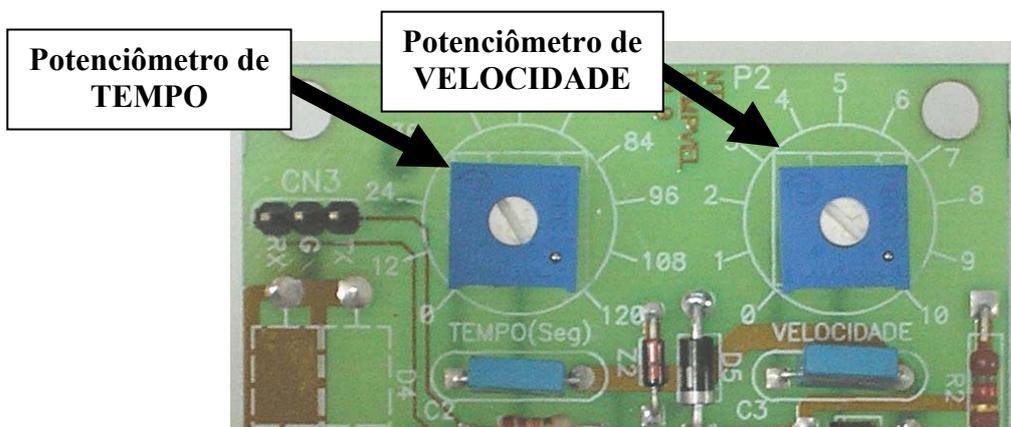
O ajuste de TEMPO na Placa Eletrônica é feito no potenciômetro P1 tendo como mínimo igual a zero e o valor máximo próximo a 2 minutos e 15 segundos. Com o auxílio
