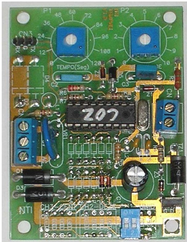
O primeiro ajuste a ser feito na Placa Eletrônica refere-se ao MODO DE TRABALHO, este ajuste é feito na chave DIP, na figura 4 é mostrada a localização da chave DIP na Placa Eletrônica.
