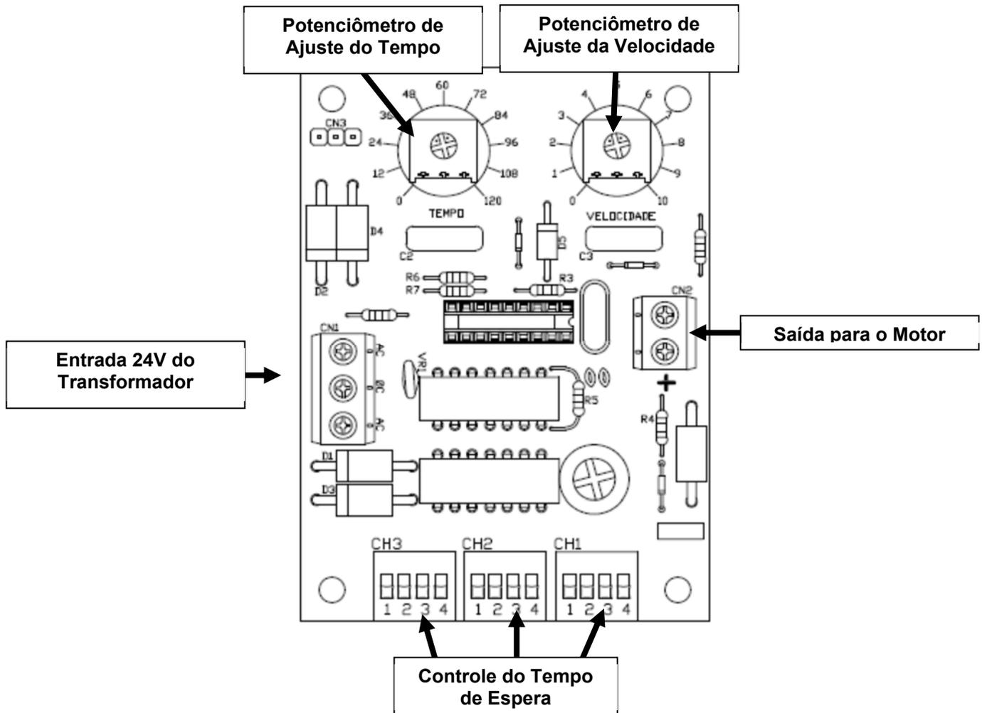
A placa que se encontra do lado direito do equipamento faz o controle da Bomba Peristáltica para a dosagem, já a placa que fica do lado esquerdo faz o controle da Purga.
