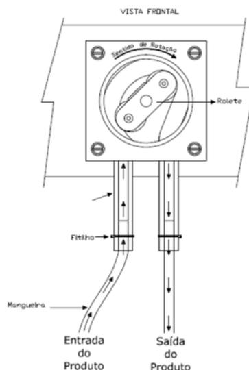
A mangueira 3/8' que fará a sucção do produto deve ser instalado com o pescador de PVC que acompanha o equipamento, para que não ocorram problemas como o da mangueira escapar. Para melhor adaptação ao sistema faça um furo na tampa bombona de produto e passe o pescador de PVC por ele, assim o produto ficará sempre fechado, evitando o contato do mesmo com o ambiente. A saída de produto da bomba peristáltica deve ser conectada à máquina.
