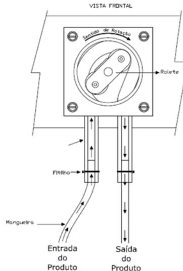
O Tubo de Nylon que fará a sucção do produto deve ser instalado com o pescador de PVC que acompanha o equipamento, para que não ocorram problemas como o da mangueira escapar. Para melhor adaptação ao sistema faça um furo na tampa bombona de produto e passe o pescador de PVC por ele, assim o produto ficará sempre fechado, evitando o contato do mesmo com o ambiente.
