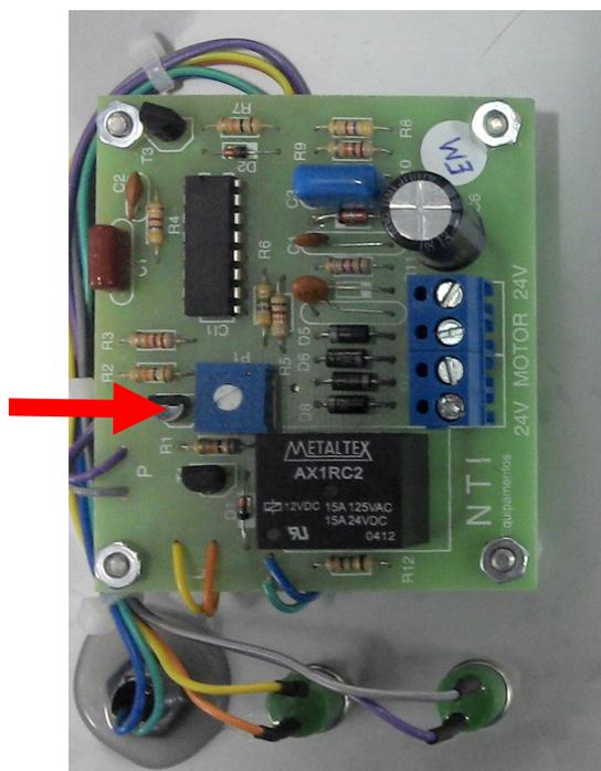
Este ajuste de temporização será feito apenas uma vez quando o equipamento for instalado, o usuário do NPC-100 não terá acesso a estes ajustes cabendo a ele apenas o comando pelo painel frontal.
