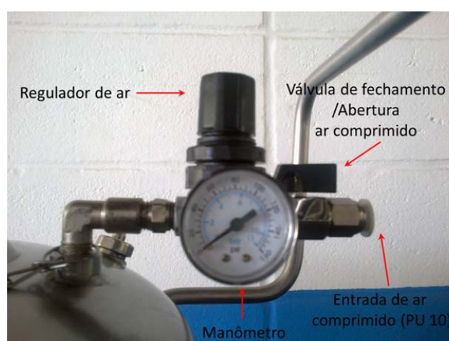
Figura 2 Detalhamento das conexões e entrada de ar.
