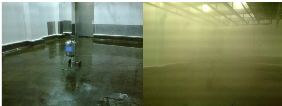
Figura 4 Esquerdo, posicionamento do Fog Master para a aplicação. Direito, névoa criada após alguns minutos de aplicação.
